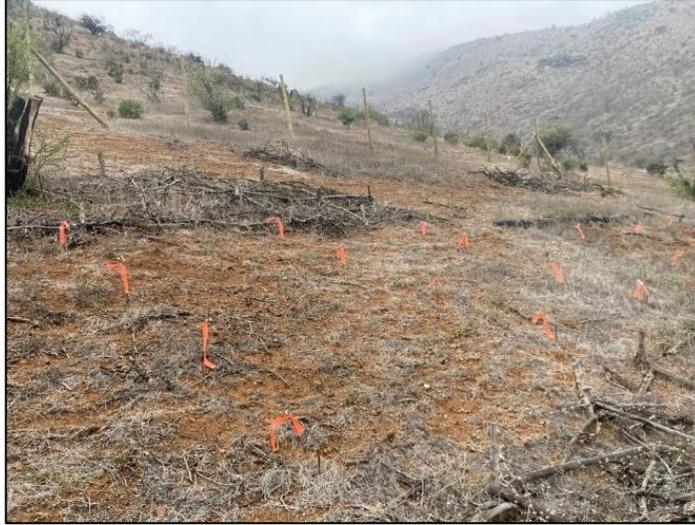
Figura 5. Fotografía en terreno de distribución de clavos de erosión en Ensayo n°2 tratamiento de cubierta superficial de ramas.
