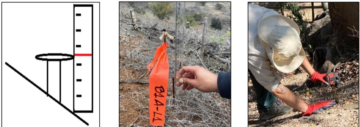
Figura 6. Figura y fotografías en terreno de la forma correcta para la medición de clavos de erosión.
